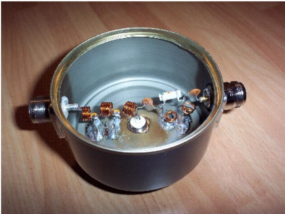
Verificate ora le saldature e pulite eventuali ossidi di saldatura con del dissossidante.
